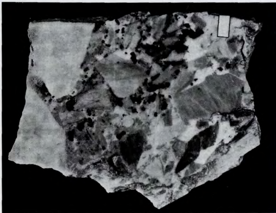
Abb. 4. Fahlerz im Bindemittel von regional z. T. schlauchförmig weit ausgedehnten Deformationsbreccien. Großanschliff. Marke = 1 cm breit. Alter Bergbau Schwaz
