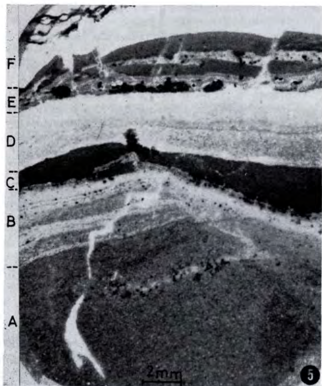
Fig. 5. I vari microstrati appaiono tanto più chiari quanto più abbondante si fa la blenda. C è una dolosiltite con diffusa pigmentazione bituminosa e contiene granuletti di blenda e pirite. Il bianco candido in A e B corrisponde a dolomite spatica. In E è manifesta la fagliatura penecontemporanea.
