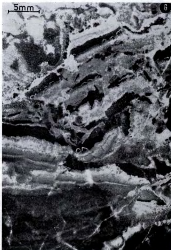
Fig. 6. Frammenti di una mm-ritmite costituita da una dolosiltite o dolopelite più (parti chiare) o meno (parti scure) ricche in blenda microgranulare. La caoticità della disposizione delle lamine è stata interpretata fondamentalmente come una struttura tipo slumping.
