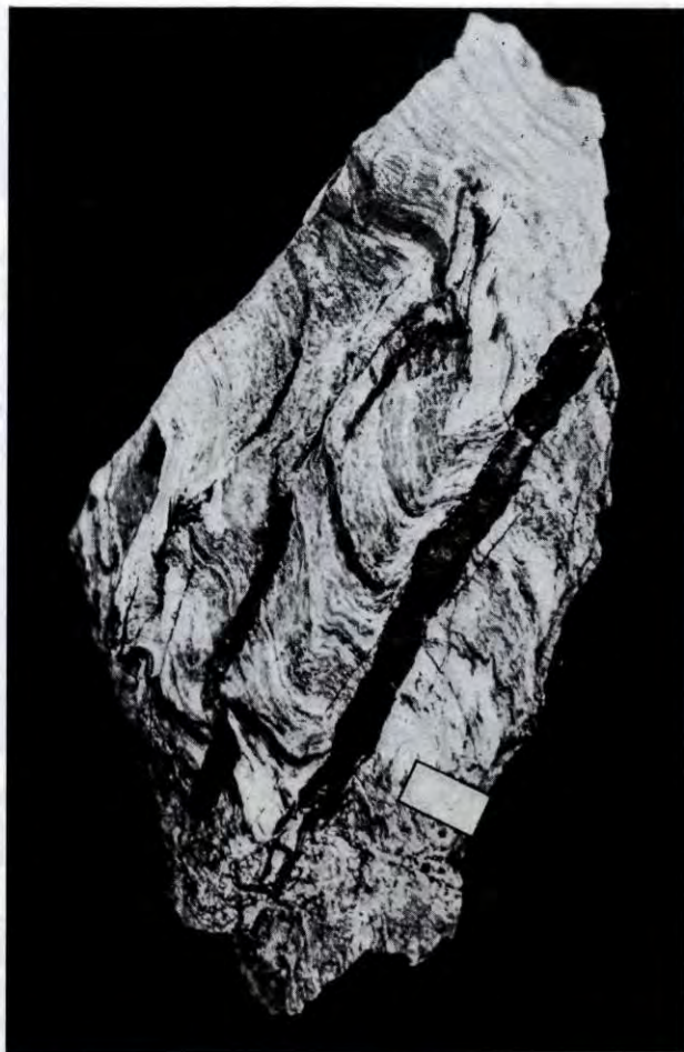
Abb. 2. Tektonische Verformung von »Siderit«-(Pistomesit)-Sericit-Chlorit-Feinschichten durch Fältelung und nachfolgende Rupturenbildung mit Pistomesit-Quarz-Kristallisation. Großanschliff, Marke = 1 cm lang. (Pistomesit: grau bis dunkelgrau, Sericit mit Feinquarz: weißgrau, Quarz: dunkelgrau). Alter Bergbau Lannern-Göbra
